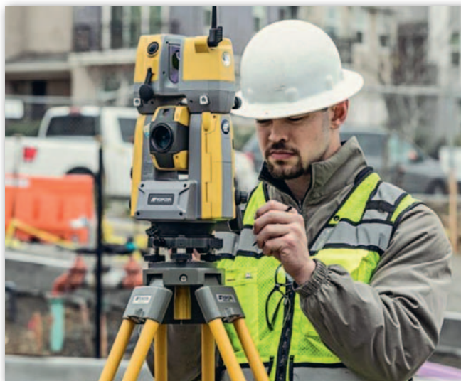
1. Skaner Topcon GTL-1000 podczas pracy
