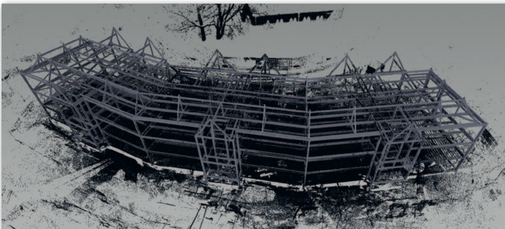
5. Chmura punktów w układzie współrzędnych modelu BIM (oprogramowanie Autodesk Navisworks)
