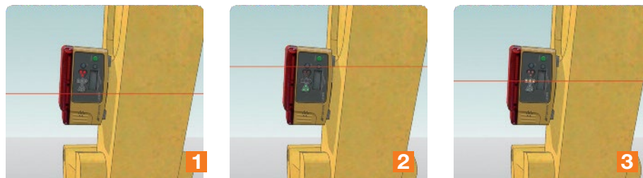
Fig.: modul de lucru pe baza indicațiilor senzorilor laser (imaginile arată senzorul montat pe excavator): 1. lama prea sus – coboară, 2. lama prea jos – ridică, 3. lama la înălțimea potrivită – păstrează cota
